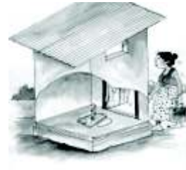
Pour Flush Latrine
